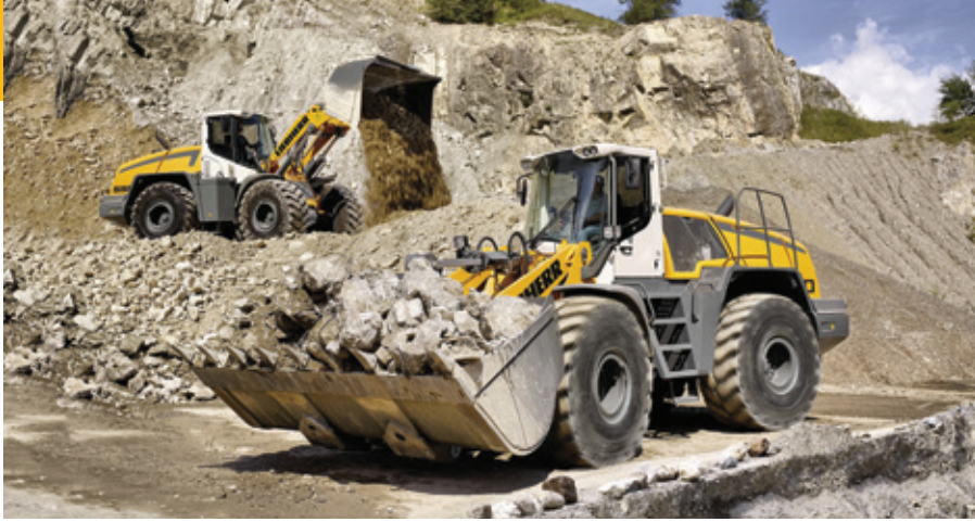
El cargador sobre ruedas L 550 de Liebherr tiene una transmisión hidroestática que está energizada con un motor diésel de 147 kW/200 HP.
