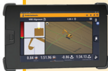
La plataforma Trimble Earthworks Grade Control transforma el control de la excavadora con automatismo 3D.
