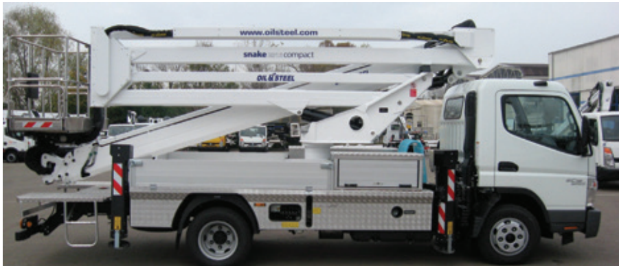
El Snake 2815 Compact es una plataforma articulada para vehículos con una capacidad nominal de carga de al menos 6 toneladas.
