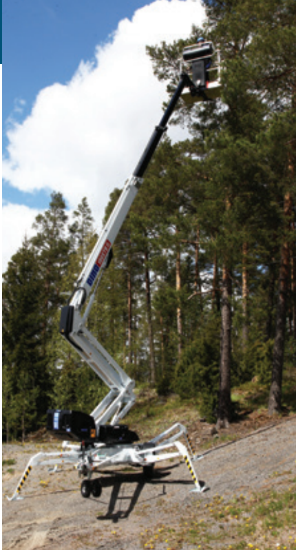
Dinolift tiene plumas sobre remolques con alturas de trabajo entre 10 y 26 metros.
