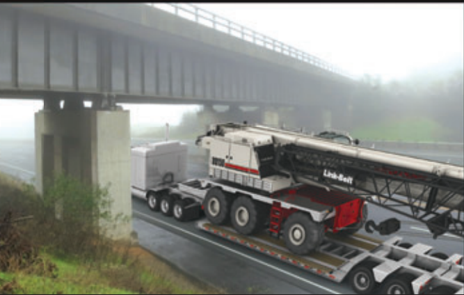
Altura del transporte inferior a 4,45 metros sobre el remolque e inferior a 3 metros de ancho CON neumáticos y brazo
