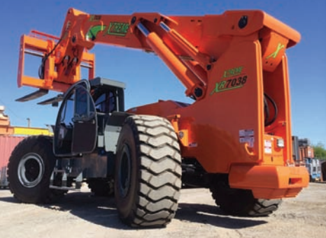
El manipulador XR7038, de Xtreme, tiene una capacidad nominal de elevación de 70.000 libras, una altura de elevación máxima de 38 pies 2 pulgadas y un peso operativo de 115.000 libras.
