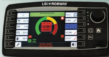
RCI-8510 Pantalla Gráfica de Sensores Múltiples & Controlador de Grúa
