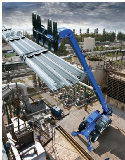
El manipulador telescópico GTH-4018 de Genie tiene una capacidad de 4.000 kilos y una altura de elevación de 18 metros.
