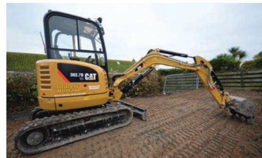
Compacta la 302.7D de Caterpillar ofrece alta producción en espacios confinados y fue configurada sin el contrapeso adicional
