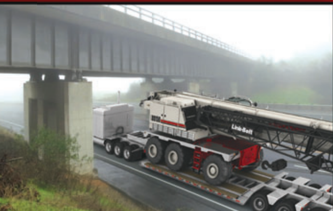
Altura del transporte inferior a 4,45 metros sobre el remolque e inferior a 3 metros de ancho CON neumáticos y brazo
