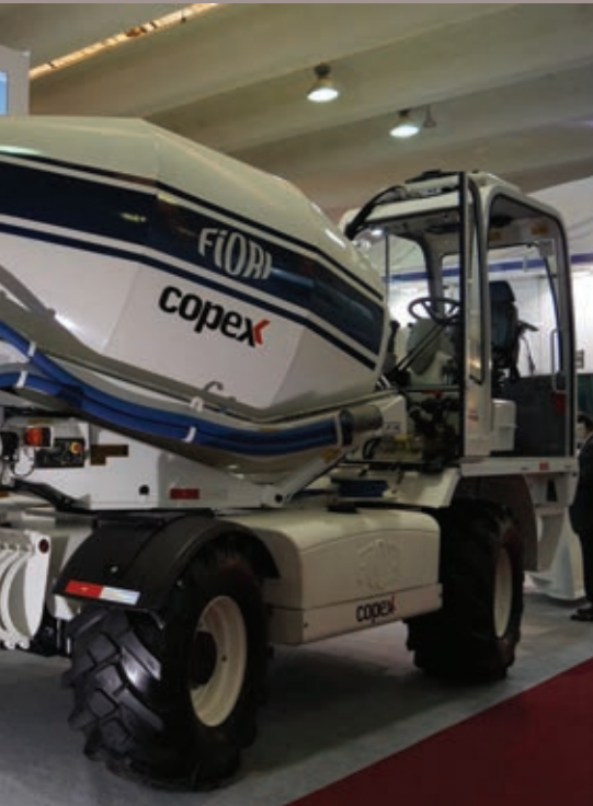
La auto hormigonera Fiori DB 260 ofrece los avances de la tecnología CBV y con giro de tambor de 360°.
