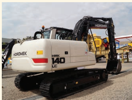
Hidromek expuso, entre sus equipos, la excavadora HMK 140 LC, la que tiene un peso operativo de 14.500 kilogramos.
