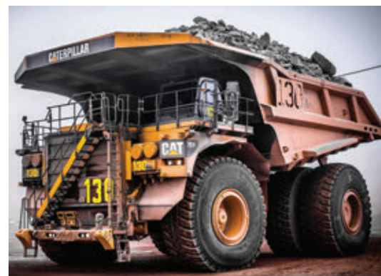
Camión Cat 797F Con 400 toneladas cortas de capacidad de carga y 4,000 HP de potencia, cada uno de estos camiones puede mover en un año más de cinco millones de toneladas
