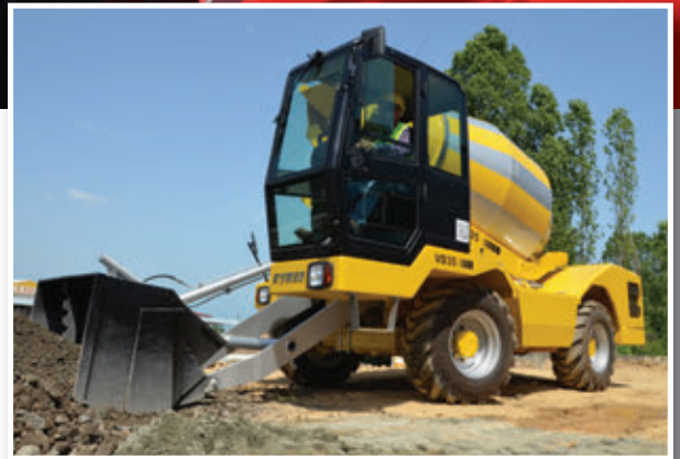
La mezcladora de hormigón VD 35 tiene una capacidad de 3,5 metros cúbicos.
