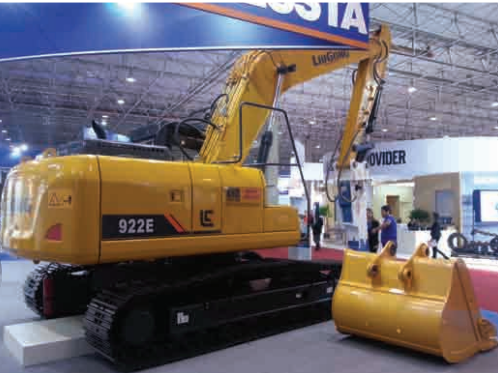
La nueva excavadora CLG922E de Liugong disminuye un 16% el consumo de combustible aumentando la eficiencia del trabajo en 3,1% en comparación a la serie anterior.
