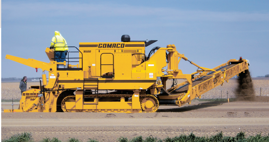
La nueva pavimentadora de concreto GOMACO 9500 trae el sistema de automatización G+.
