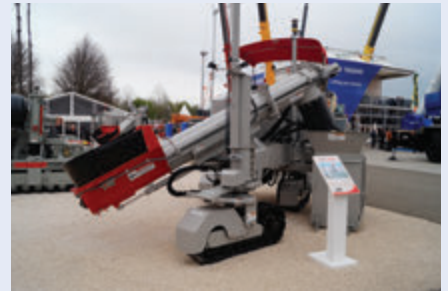
Power Curbers expuso su máquina para bordillos y cunetas 5700-C equipado con su sistema MAX.
