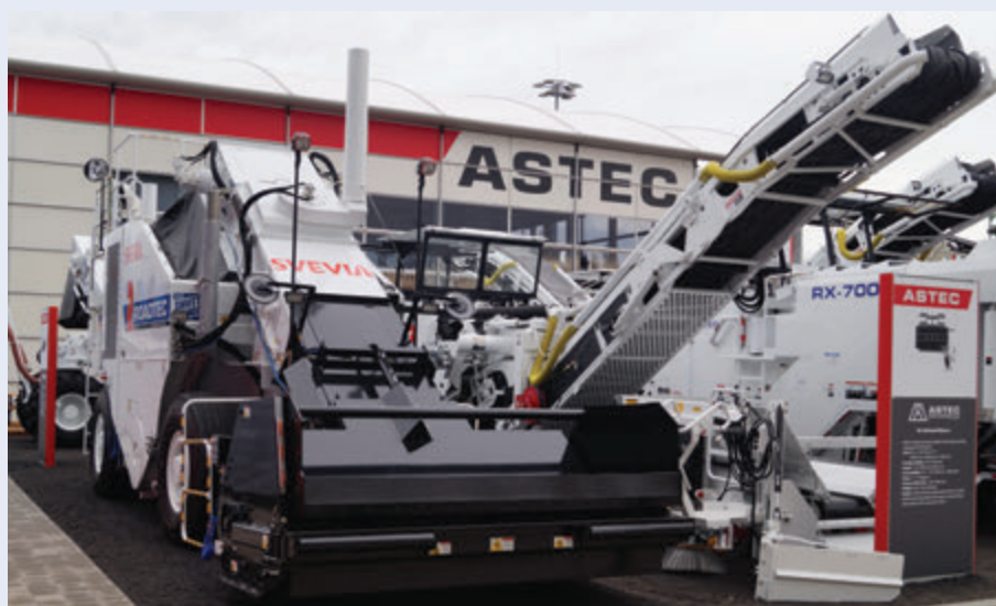
Astec, dentro de sus equipos, exhibió el vehículo de transferencia de material Shuttle Buggy.
