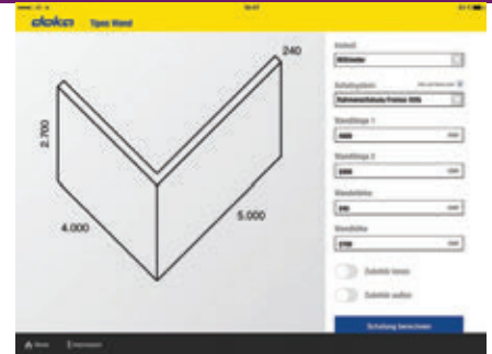
Doka Tools, el sistema de cálculos para encofrados Doka Flex, está disponible para móviles, tablets y computadores.
