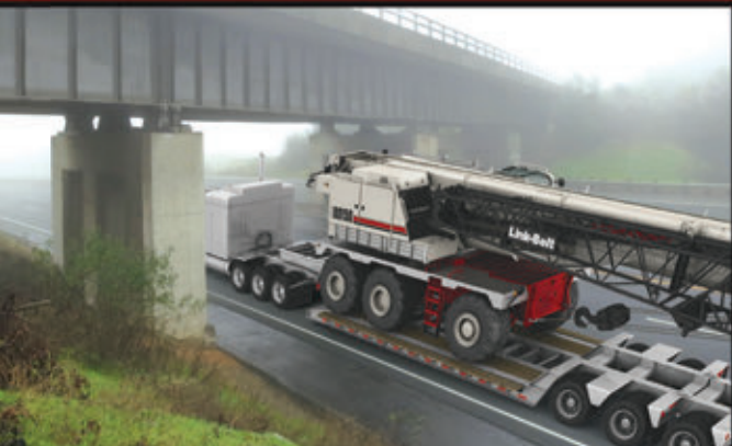
Altura del transporte inferior a 4,45 metros sobre el remolque e inferior a 3 metros de ancho CON neumáticos y brazo
