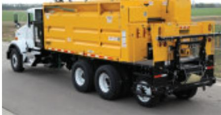
**La extendidora montada sobre camión M212 de Bergkamp, está impulsada por motor diésel Cummins de 99 HP localizado al frente y dentro de un compartimiento cerrado, para la reducción del ruido como de la vibración.**
