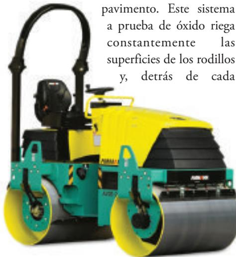
**La serie de rodillos vibradores tándem AV2-2 de Ammann es ideal para obras de tamaño medio, eficaz en la compactación tanto de capas sub-base como de rodadura o de asfalto.**
