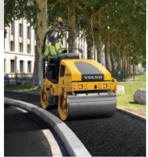
boquilla de riego se sitúan filtros finos que minimizan las obstrucciones y distribuyen de forma adecuada el agua en las superficies de los rodillos. Otra característica es su nuevo motor diésel de tres cilindros que desarrolla 24,8 kW.
