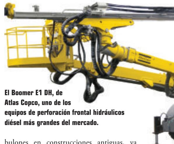
**El Boomer E1 DH, de Atlas Copco, uno de los equipos de perforación frontal hidráulicos diésel más grandes del mercado.**
