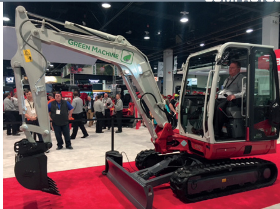
Takeuchi lanzó una excavadora a batería de cuatro toneladas en ConExpo 2017 llamada E240 Green Machine.
