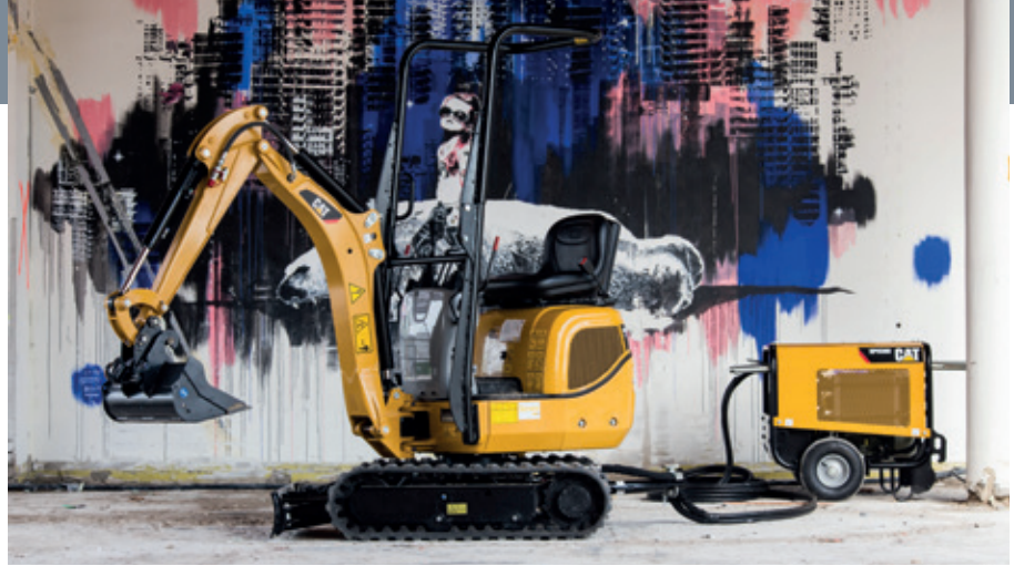
La más reciente mini excavadora de Caterpillar, la CAT 300.9D VPS, viene con una unidad de poder independiente.
