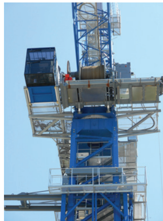
La nueva cabina de aristas rectas montada sobre una grúa abatible en la fábrica de Linden Comansa, en Pamplona.
