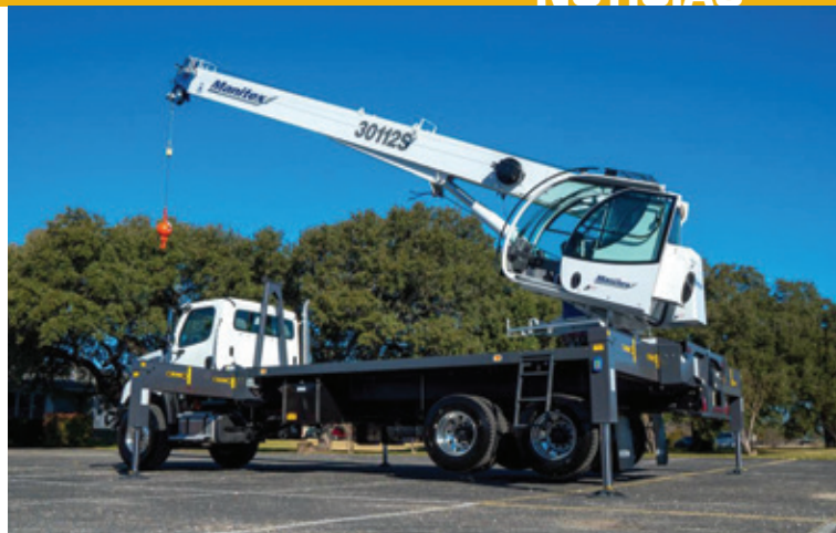
La TC30112 incorpora una nueva cabina con la capacidad de inclinarse en 20° para un mayor confort del operador.
