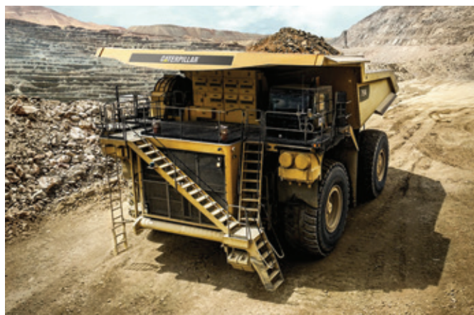
El Cat 794 AC, equipo con una capacidad de carga de 320 toneladas y una potencia de 3.500 HP.
