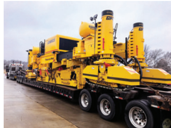
La pavimentadora de concreto GP4 de GOMACO tiene la capacidad de pavimentar hasta 12,2 metros de ancho.
