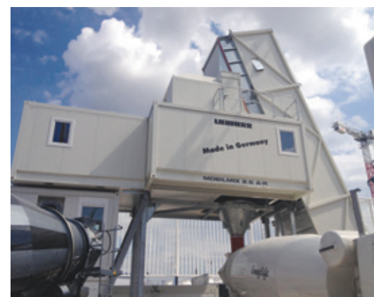
La nueva central mezcladora Liebherr Mobilmix 2.5, que tiene alta capacidad sin dejar de ser modular y móvil.
