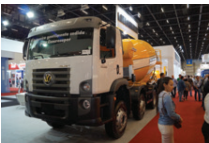
Liebherr expuso su hormigonera con control electrónico de velocidad para las vueltas del tambor.
